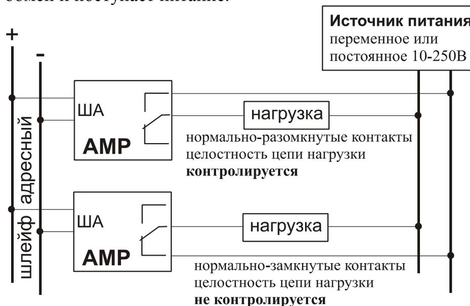
Схема подключения АМР
