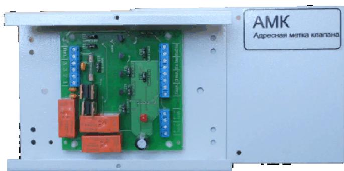
Адресная метка клапана АМК-1 является микропроцессорным устройством и предназначена для **управления внешней нагрузкой** (приводом клапана, задвижки и т.п.) через сухие контакты реле **с контролем целостности управляемой цепи**. АМК-1 контролирует состояние датчиков по-
