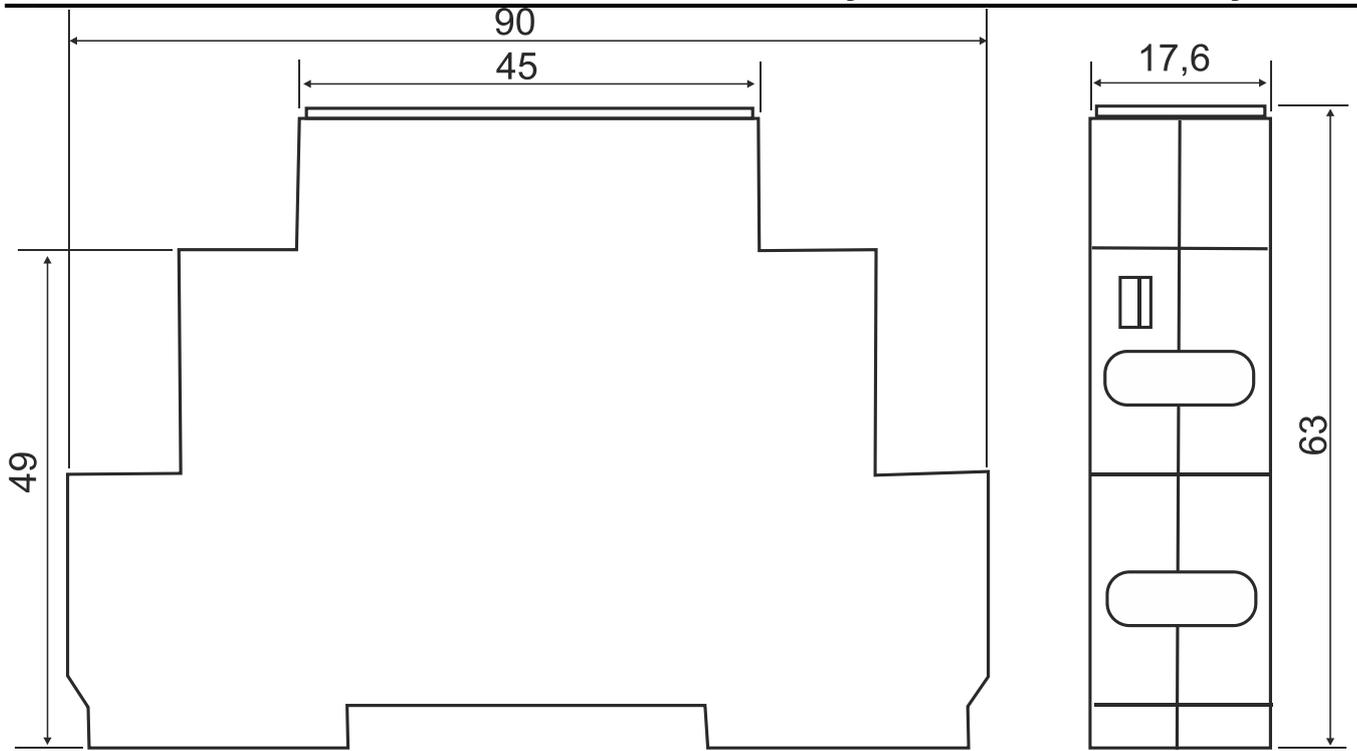
**Рис.15** Габаритные и установочные размеры АМТШ (исп.3), АМДШ (исп.3), ИЗО-1 (исп.3), ИЗО-2 (исп.3)
