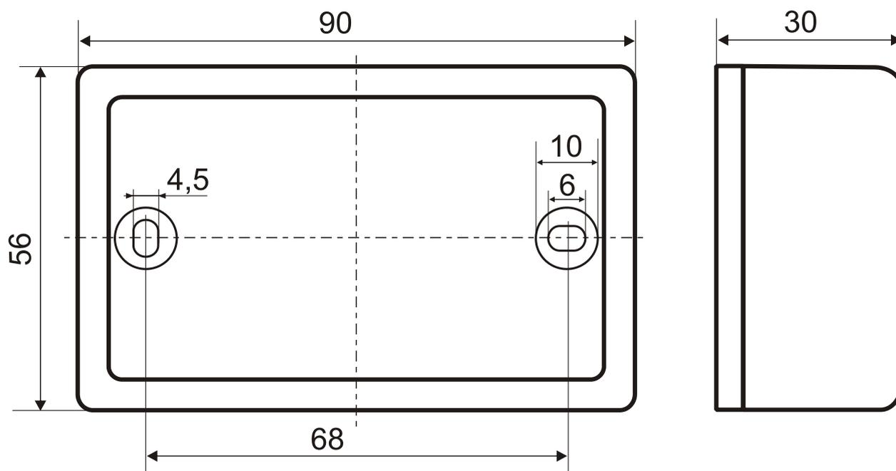
Рис.10 Габаритные и установочные размеры АМР (исп.1), АМП (исп.1), АМУ (исп.1), ПИ-2, МС-3 (исп.1), Р1-50 (исп.1), Р2-20 (исп.1)
