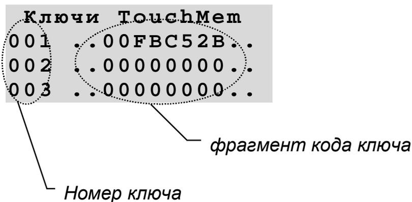
где фрагмент кода ключа - это часть кода ключа, выгравированного на нем (см. рисунок).
