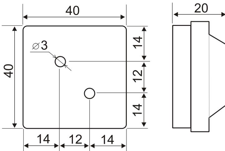
Рис.14 Габаритные и установочные размеры ОЭ-2 (исп.1), ОЭ-3 (исп.1)
