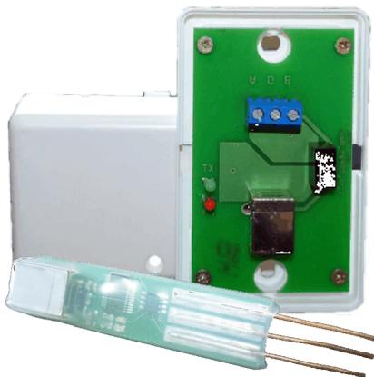
Преобразователи интерфейса USB ↔ RS-485 служат для связи центральных блоков ПКП-1А с ПК (персональным компьютером), с целью передачи (чтения и записи) информации при работе с различными прикладными программами. При этом пользователю становятся доступны следующие функции:
