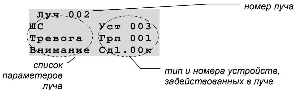
В левой колонке, где указываются типы и номера устройств, задействованных в луче, возможны следующие обозначения:
