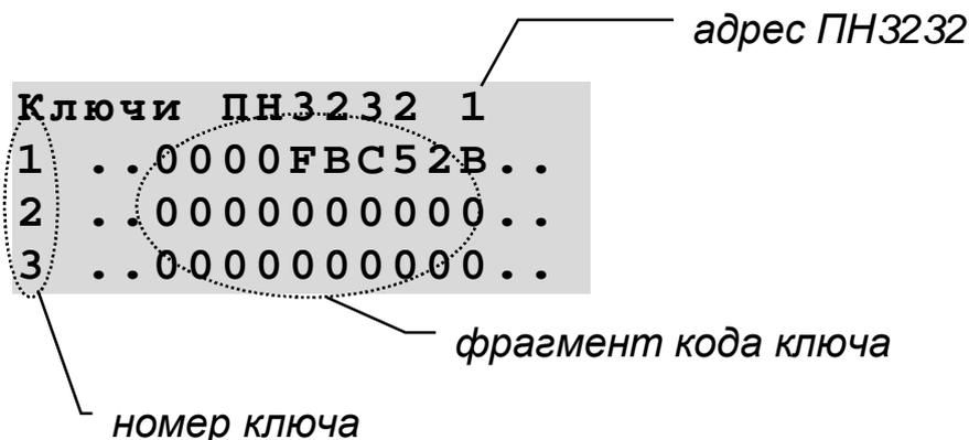
где фрагмент кода ключа - это часть кода ключа, выгравированного на нем (см. рисунок).
