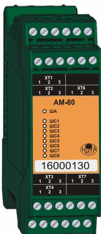
Адресная метка восьмивходовая АМ-80 является микропроцессорным устройством и предназначена для сбора информации с нормально-замкнутых или нормально-разомкнутых «сухих» контактов. Адресная метка включается в адресно-аналоговый шлейф (протоколы ДОЗОР, ДОЗОР-07а, ДОЗОР-ЛЕО), формируемый центральным блоком ПКП-1А прибора «ДОЗОР-1А», по которому происходит информационный обмен и поступает питание.
