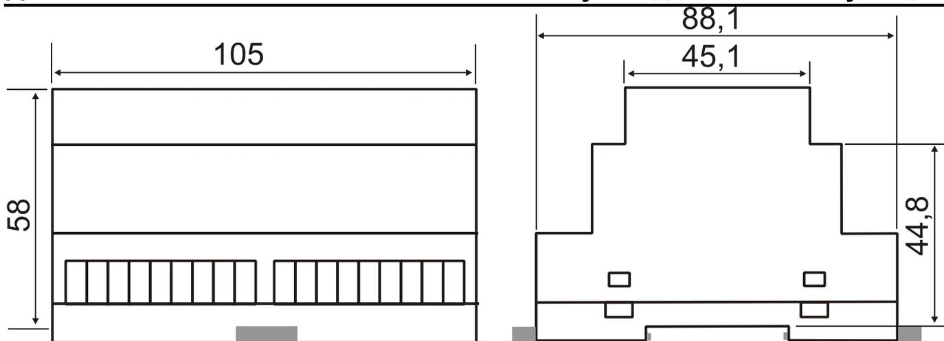
Рис.7 Габаритные и установочные размеры ПКП-1А-4 (исп.2), АМК-1 (исп.3)
