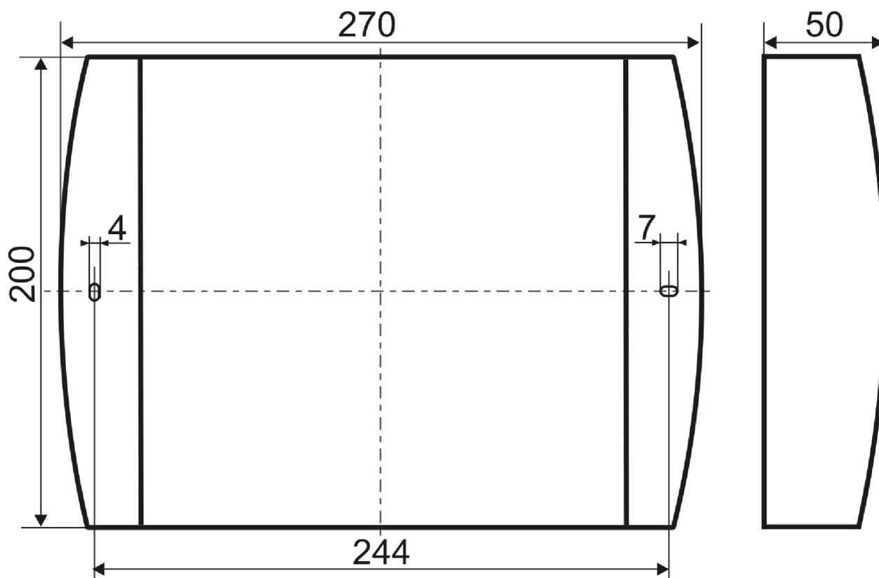
Рис.2 Габаритные и установочные размеры ПКП-1А-3
