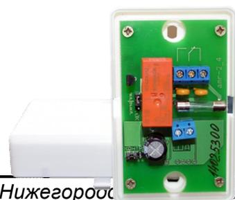
включается в адресный шлейф (протоколы ДОЗОР, ДОЗОР-07а, ДОЗОР-ЛЕО или ХР95), формируемый центральным блоком ПКП-1А прибора «ДОЗОР-1А», по которому происходит информационный обмен и поступает питание. При подключении меток АМР соблюдать полярность не требуется.
