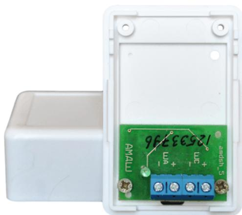
Адресная метка АМДШ является микропроцессорным устройством и предназначена для формирования **порогового шлейфа сигнализации** для **дымовых** или любых контактных датчиков с **нормально-разомкнутыми** контактами. Адресная метка **обеспечивает питание токопотребляющих датчиков**. Адресная метка включается в адресный шлейф (протоколы ДОЗОР, ДОЗОР-07а, ДОЗОР-ЛЕО или ХР95), формируемый центральным блоком ПКП-1А прибора «ДОЗОР-1А», по которому происходит информационный обмен и
