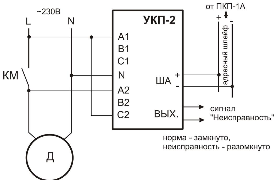
**Схема подключения однофазная**
