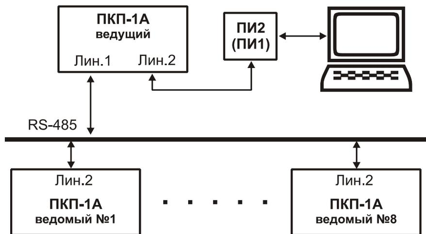
Преобразователь ПИ-1 не имеет гальванической развязки и используется для подключения ПК на относительно небольшом удалении от ПКП-1 для программирования или пуско-наладочных работ. Удаленность составляет несколько метров и ограничена длиной стандартного USB-кабеля.
