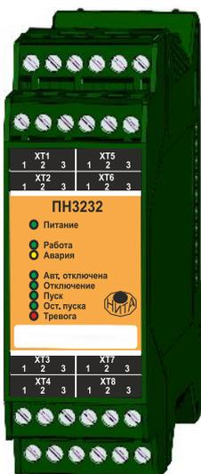
Пульт предназначен для организации управления и выносной индикации на передней крышке шкафа автоматики и устанавливается на ДИН-рейку в шкаф. К каждому выходному контакту К1-К18 может быть подключена либо кнопка с нормально-разомкнутыми контактами, либо световой индикатор или световой сигнализатор с током потребления до 100мА и рабочим напряжением до 30В (далее – индикатор). Для индикатора доступны все режимы работы, определенные в конфигураторе:
