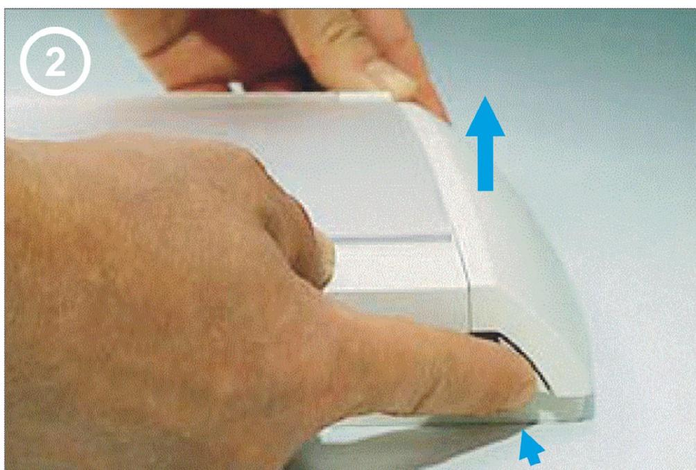
**Рис.4** Разборка корпуса ПКП-1А-3
