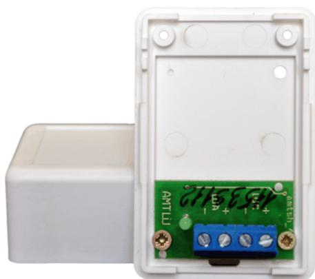
Адресная метка АМТШ является микропроцессорным устройством и предназначена для формирования **порогового шлейфа сигнализации (ШС)** для **тепловых** или любых контактных датчиков с **нормально-замкнутыми** контактами. Адресная метка включается в адресный шлейф (протоколы ДОЗОР, ДОЗОР-07а, ДОЗОР-ЛЕО или ХР95), формируемый центральным блоком ПКП-1А прибора «ДОЗОР-1А», по которому происходит информационный обмен и поступает питание.
