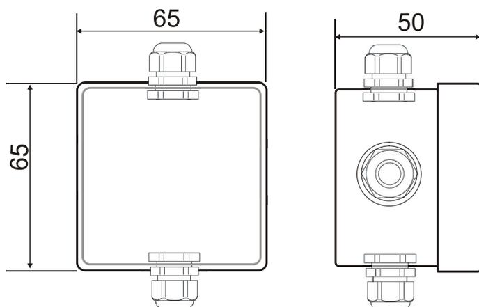
На коробке могут быть установлены до 4 гермовводов типа RG7 -RG16
