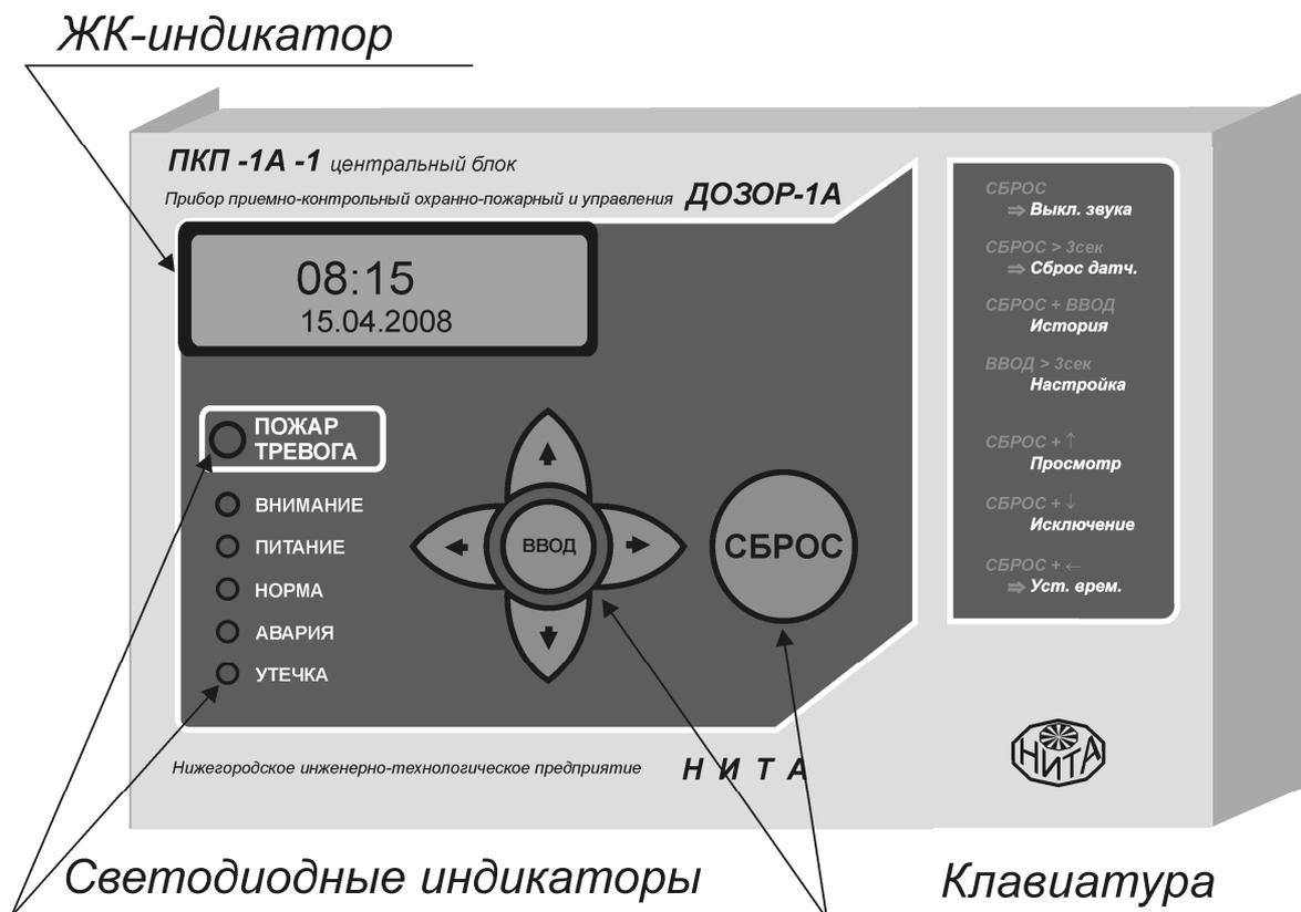
**ЖК индикатор** – жидкокристаллический индикатор, графический (с различными шрифтами), предназначен для вывода информации о текущем состоянии прибора, обнаруженных тревогах, неисправностях, пунктах меню при его конфигурировании и т.п.;
