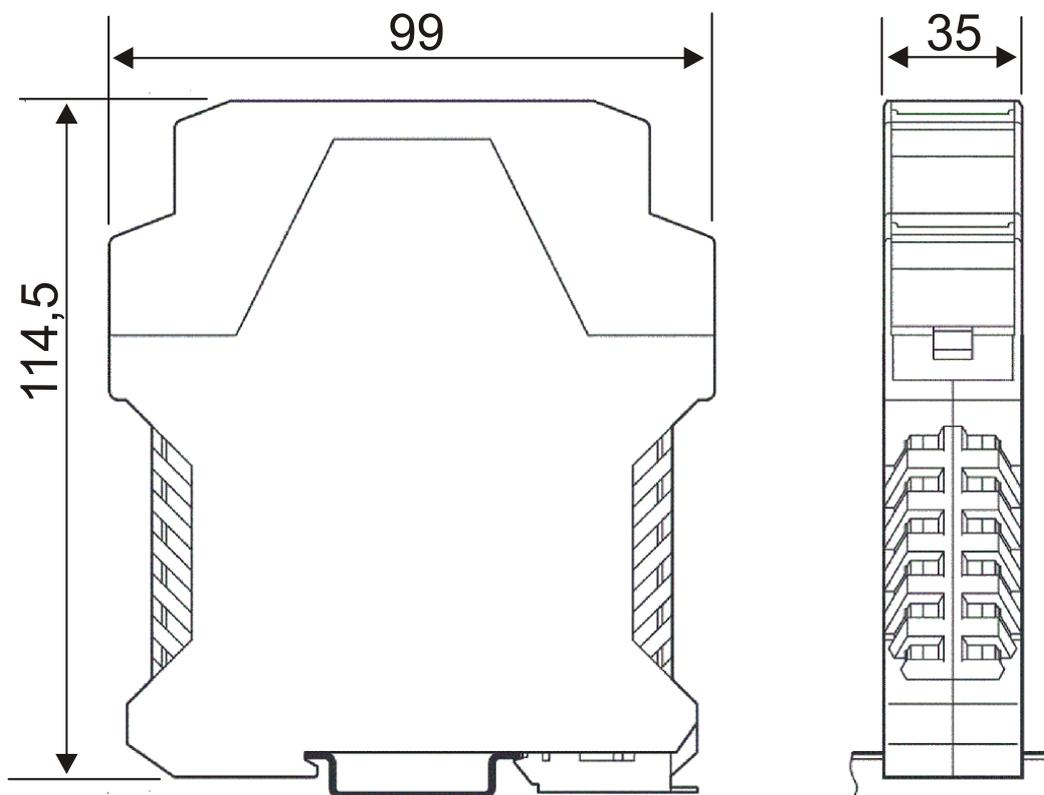
Рис.6 Габаритные и установочные размеры ПКП-1А-4 (исп.1), ПН3232 (исп.2), АМ-04, АМ-80, АМ-42
