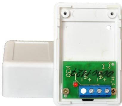
Изолятор ИЗО-2 предназначен для изоляции участка адресной линии (протокол ЛЕОНАРДО System Sensor) при её коротком замыкании. Изоляторы устанавливаются в разрывы адресной линии, формируемой модулем сопряжения МС-2 и входящим в состав прибора Дозор-1А. При коротком замыкании между двумя изоляторами такой участок перестает функционировать, а все остальные участки продолжают нормально работать (при кольцевой схеме построения адресного шлейфа). Изолятор является самостоятельным
