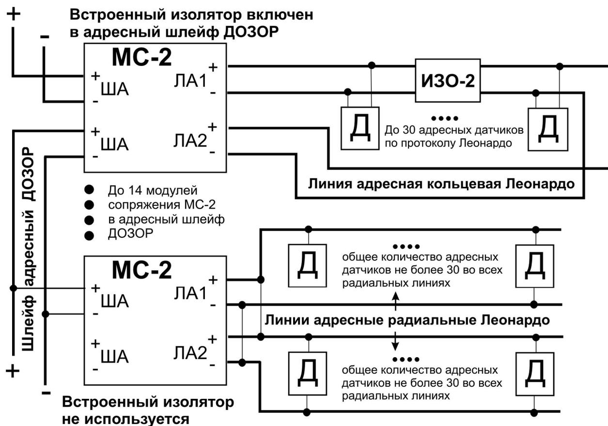
Модуль МС-2 имеет встроенный изолятор короткого замыкания адресного шлейфа ДОЗОР, его использование или неиспользование в структуре адресного шлейфа ДОЗОР определяется схемой подключения контактов «ША».
