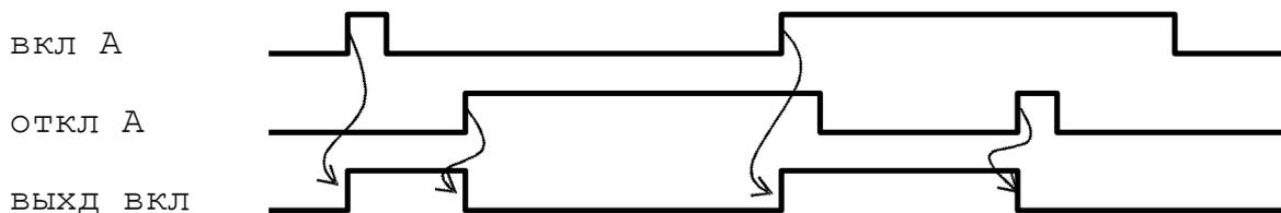
Пропадание сигнала блокировки автоматического управления вызовет включение или отключение выхода, если управляющий сигнал будет активен. Пример такой ситуации приведен на рисунке:
