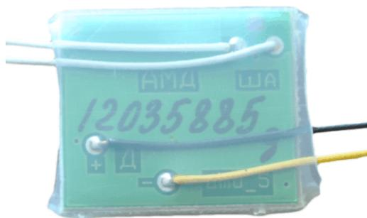
Адресная метка АМД является микропроцессорным устройством и предназначена для формирования адреса у дымового или любого контактного датчика с нормально-разомкнутыми контактами. Адресная метка включается в адресный шлейф (протоколы ДОЗОР, ДОЗОР-07а, ДОЗОР-ЛЕО или ХР95), формируемый центральным блоком ПКП-1А
