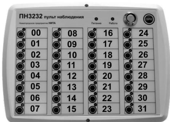
двухцветных светодиодных индикаторах и управления системой при помощи кнопок. Связь с центральным блоком ПКП-1А осуществляется по каналу RS-485. Питается пульт ПН3232 от внешнего источника питания 10-30В. С одним ПКП-1А можно связать до 8 пультов ПН3232. Пульт изготавливается в двух вариантах исполнения.
