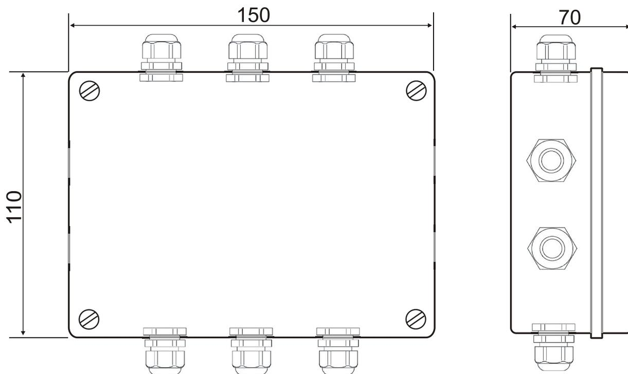
На коробке могут быть установлены до 10 гермовводов типа RG7 -RG16
