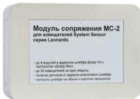
Модуль сопряжения МС-2 предназначен для сопряжения адресных датчиков, производства компании Систем Сенсор серия Леонардо, с прибором Дозор-1А в составе адресного шлейфа, работающего по протоколам ДОЗОР-ЛЕО или ДОЗОР-07а. Модуль получает питание от адресного шлейфа и формирует одну кольцевую адресную линию, в которые может подключаться до 30 адресных извещателей по протоколу ЛЕОНАРДО
