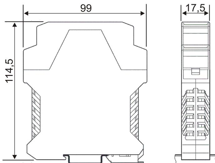
**Рис.17** Габаритные и установочные размеры УКП-2
