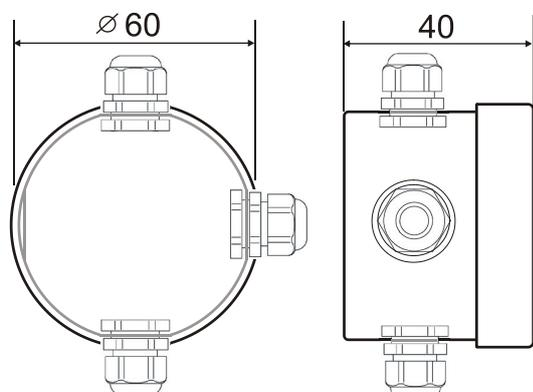
На коробке могут быть установлены до 4 гермовводов типа RG11
