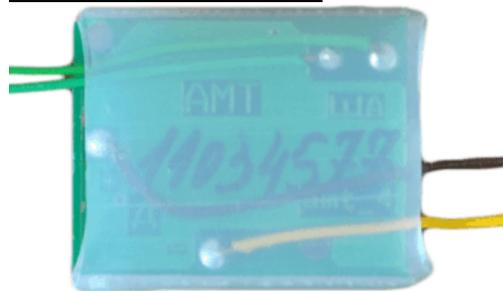
Адресная метка АМТ является микропроцессорным устройством и предназначена для формирования адреса у одного теплового или любого контактного датчика с нормально-замкнутыми контактами. Адресная метка включается в адресный шлейф (протоколы ДОЗОР, ДОЗОР-07а, ДОЗОР-ЛЕО или ХР95), формируемый центральным блоком ПКП-1А прибора «ДОЗОР-1А», по которому происходит информационный обмен и поступает питание. При подключении меток АМТ соблюдать полярность не требуется.
