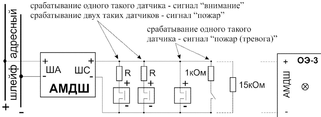
Схема подключения АМДШ
