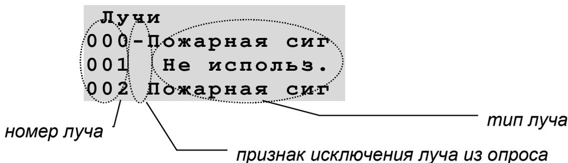
Затем надо подвести указатель к признаку исключения из опроса для интересующего луча и нажать кнопку ВВОД. Значение признака поменяется на противоположное. Наличие знака "-" после номера луча означает, что он исключен из опроса и, после выхода из режима конфигурирования, этот луч будет рассматриваться как неиспользуемый (блокированный).
