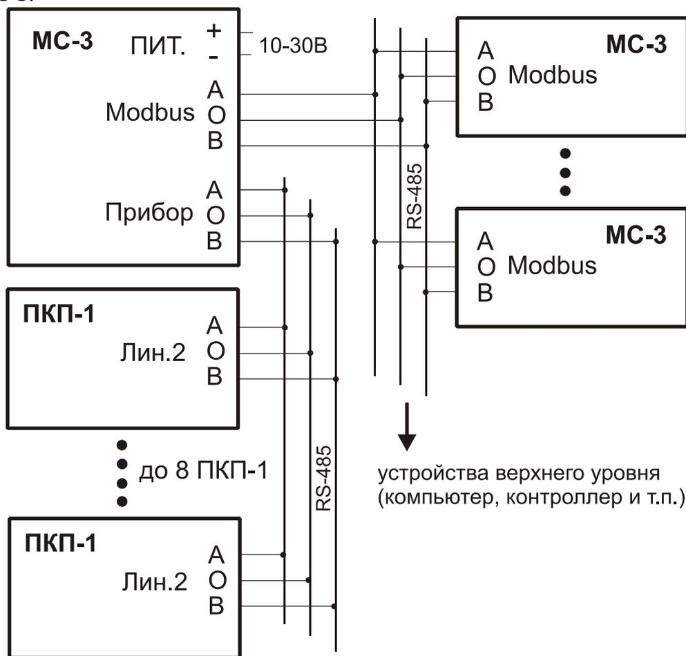
Схема подключения МС-3
