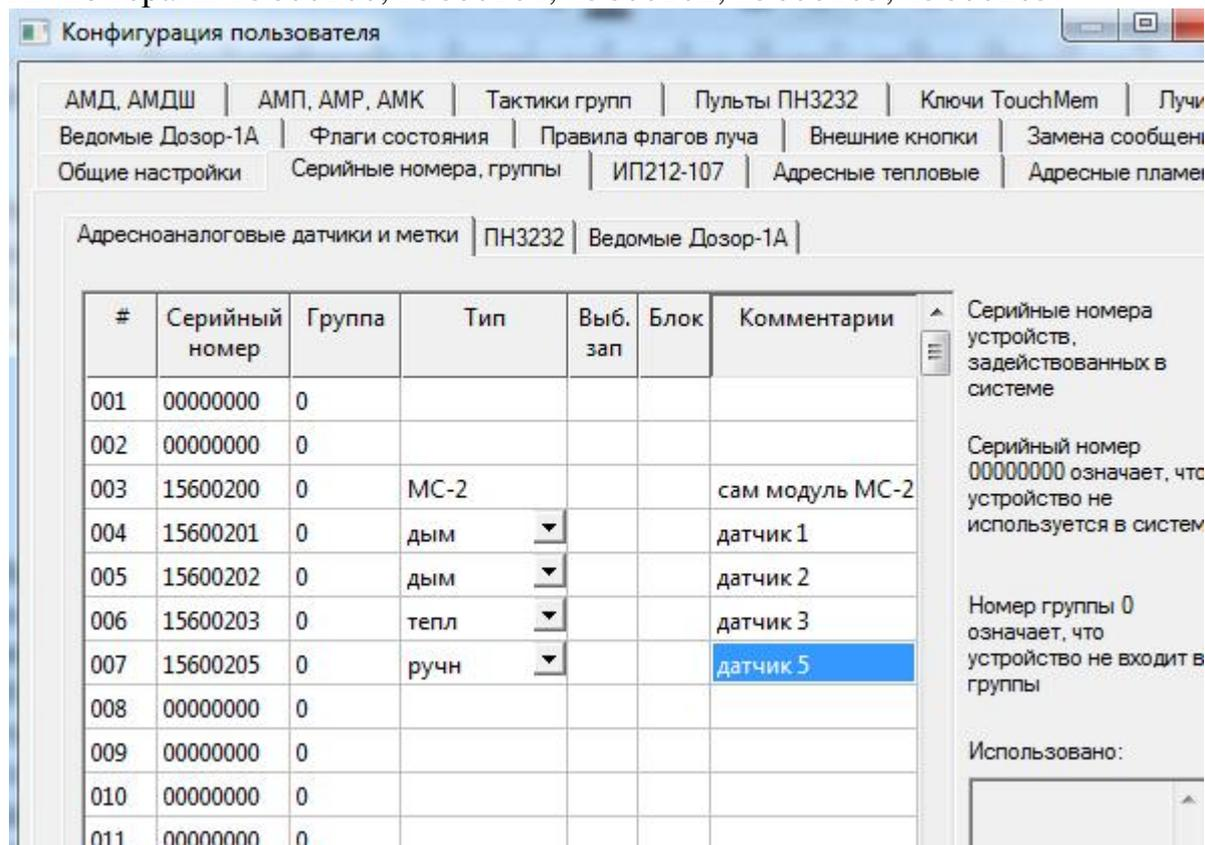
В конфигурации прибора Дозор-1А, тип устройства для датчиков серии Леонардо надо устанавливать вручную. Тип устройства МС-2 определяется автоматически по его серийному номеру.
