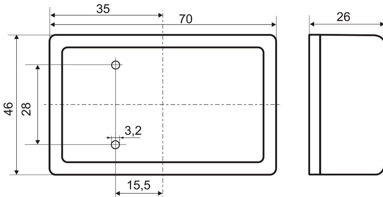
Рис.9 Габаритные и установочные размеры АМТШ (исп.1), АМДШ (исп.1), ИЗО-1 (исп.1), ИЗО-2 (исп.1)
