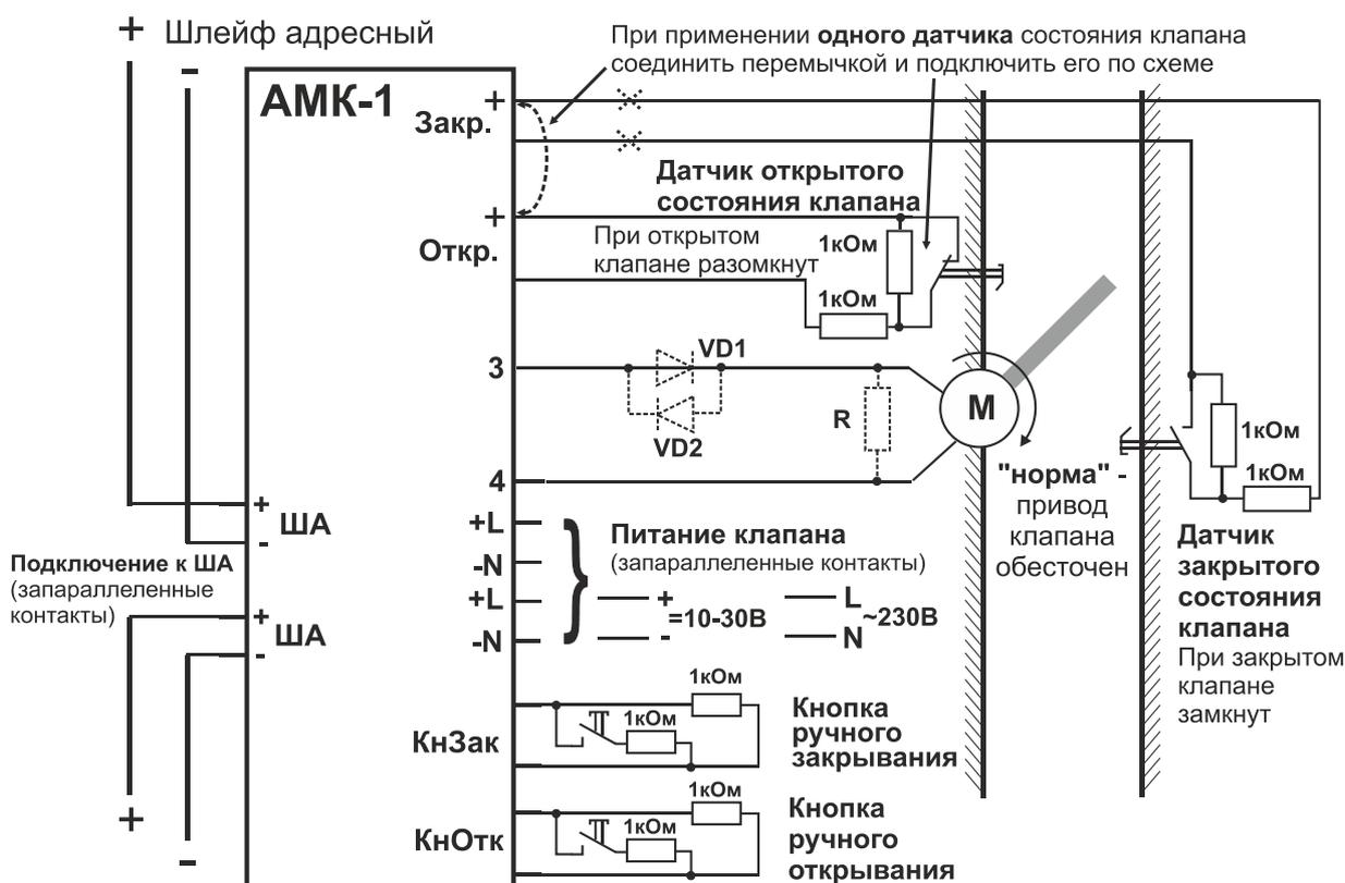
Схема подключения нормально-выключенного привода с одним вводом
