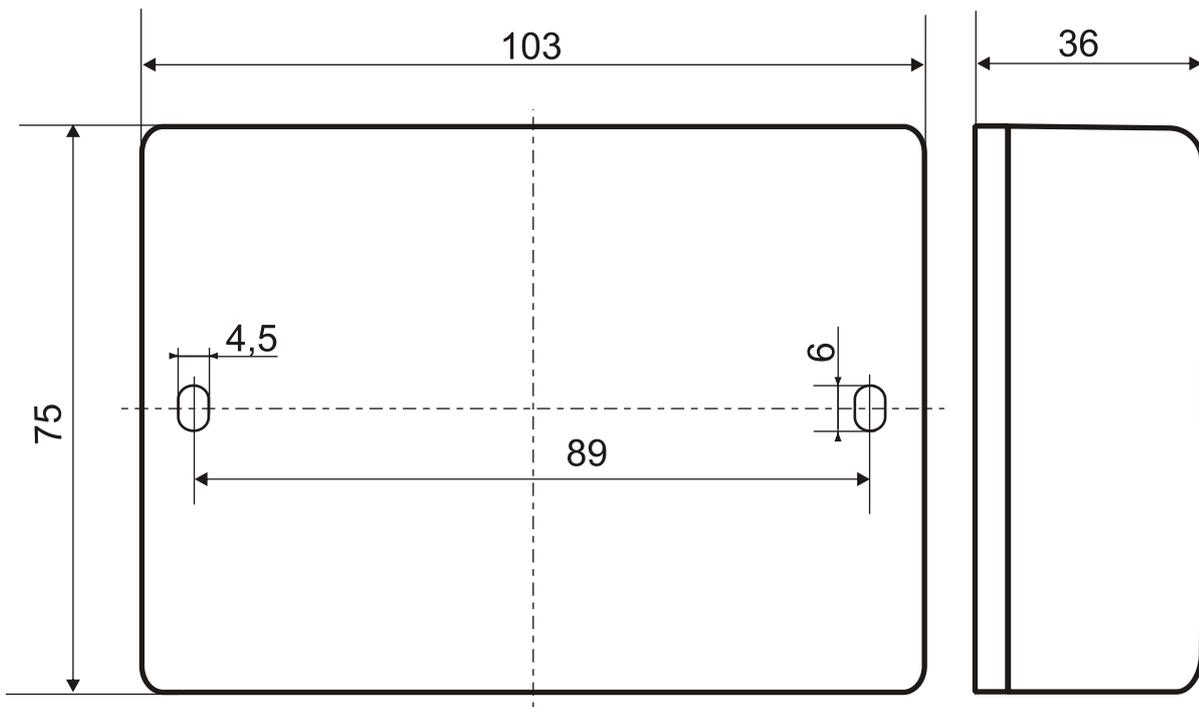
Рис.13 Габаритные и установочные размеры МС-2 (исп.1)
