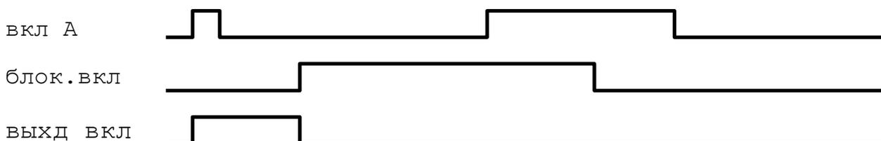
Выходные сигналы «Управляемый выход вкл» и «Управляемый выход откл», при отсутствии блокировок, работают в противофазе, т.е. в исходном состоянии (после включения питания или после выхода из режима конфигурирования) «Управляемый выход вкл» выключен, а «Управляемый выход откл» включен. При включении «Управляемый выход вкл» отключается «Управляемый выход откл». При появлении сигнала блокировки противофазность может нарушиться (см. предыдущий абзац про работу сигналов блокировки)
