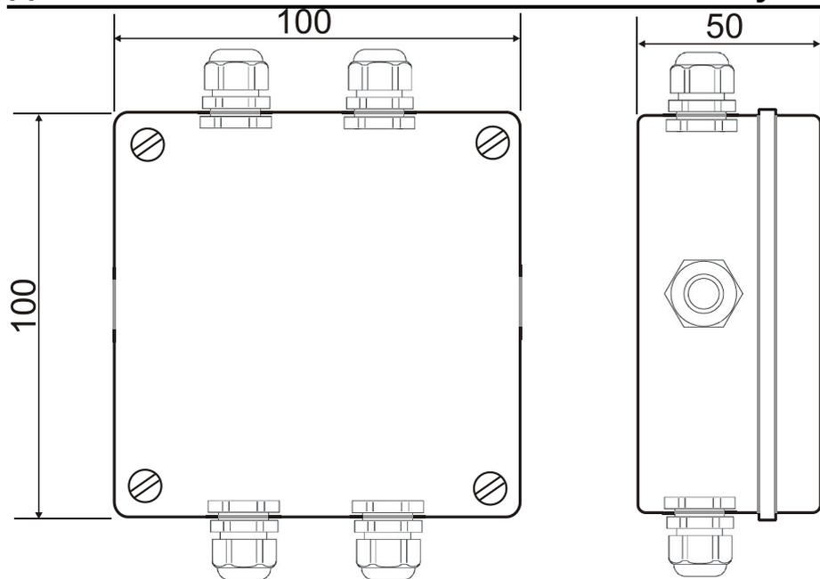
На коробке могут быть установлены до 6 гермовводов типа RG7 -RG16
