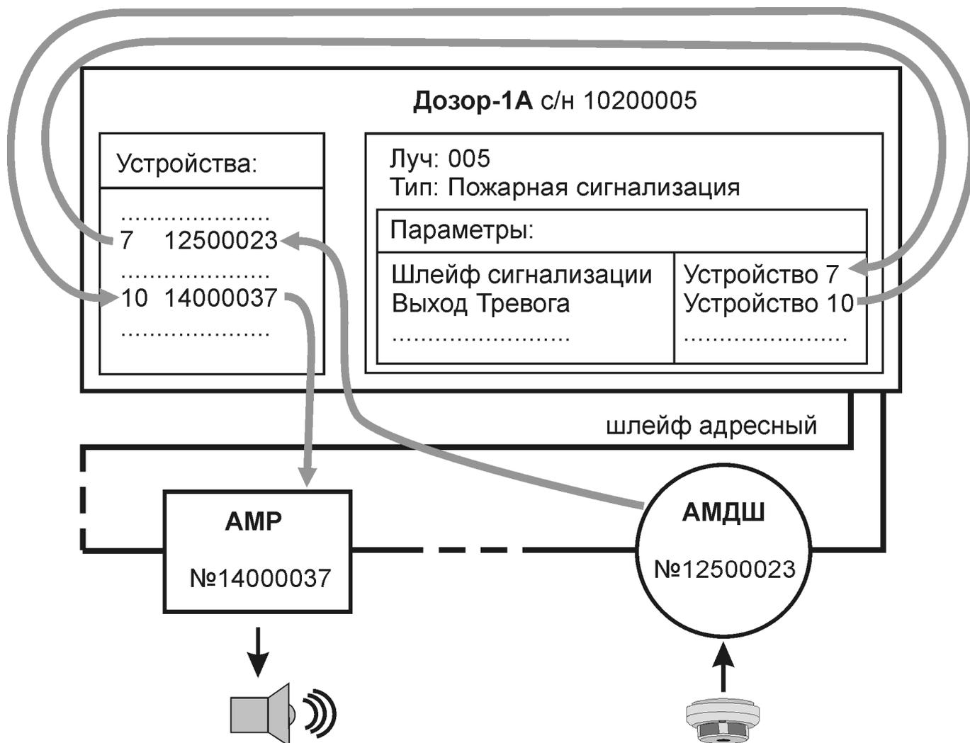
Красными линиями показано направление прохождения сигнала тревоги. В данном примере, в адресный шлейф прибора ДОЗОР-1А включены адресные метки АМДШ (с серийным номером 12500023), а также АМР (с серийным номером 14000037). Также не исключено наличие прочих адресных устройств (на рисунке они не показаны). К АМДШ подключены дымовые пожарные извещатели. В свою очередь АМР коммутирует включение звуковой сирены, подключенной к метке через блок питания.
