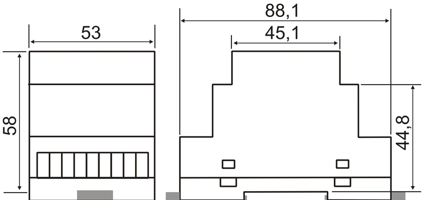
**Рис.16** Габаритные и установочные размеры АМР (исп.3), АМУ (исп.3), МС-2 (исп.3), МС-3 (исп.3), Р1-50 (исп.3), Р2-20 (исп.3)
