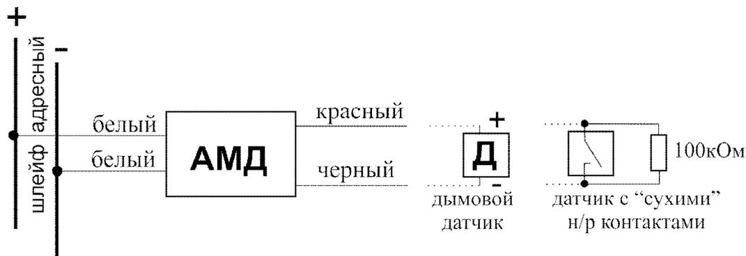
Схема подключения АМД
