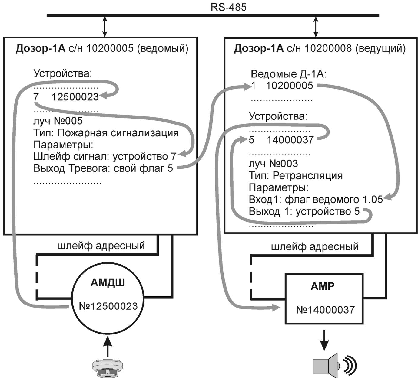
Прохождение сигнала тревоги от датчика до реле в системе с тремя приборами, датчик подключен к ведомому прибору, реле к другому ведомому, сигнал на включение передается через ведущего.
