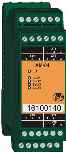
Адресная метка четырехканальная АМ-04 является микро-процессорным устройством и предназначена для управления нагрузкой с контролем нормально-разомкнутой цепи на обрыв, замыкание и пропадание питающего напряжения. Адресная метка включается в адресно-аналоговый шлейф (протоколы ДОЗОР, ДОЗОР-07а, ДОЗОР-ЛЕО), формируемый центральным блоком ПКП-1А прибора «ДОЗОР-1А», по которому происходит информационный обмен и поступает питание.
