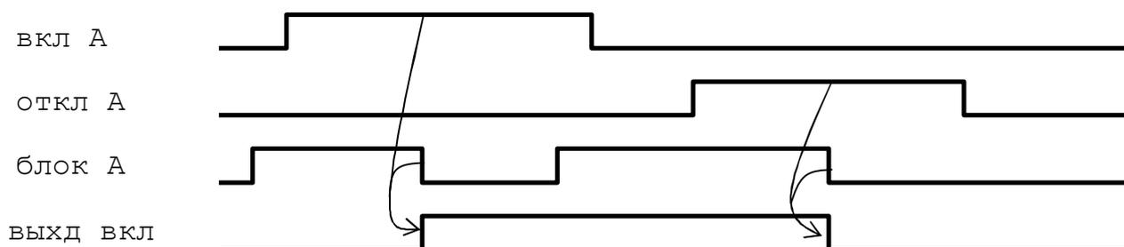
При одновременном появлении команд на включение и на отключение, приоритет будет у сигнала отключения.
