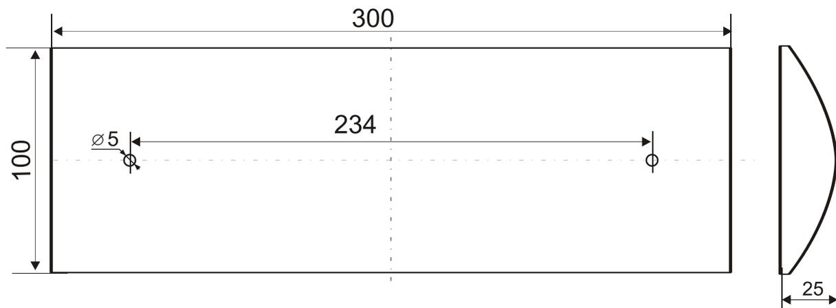
Рис.12 Габаритные и установочные размеры АСО Люкс
