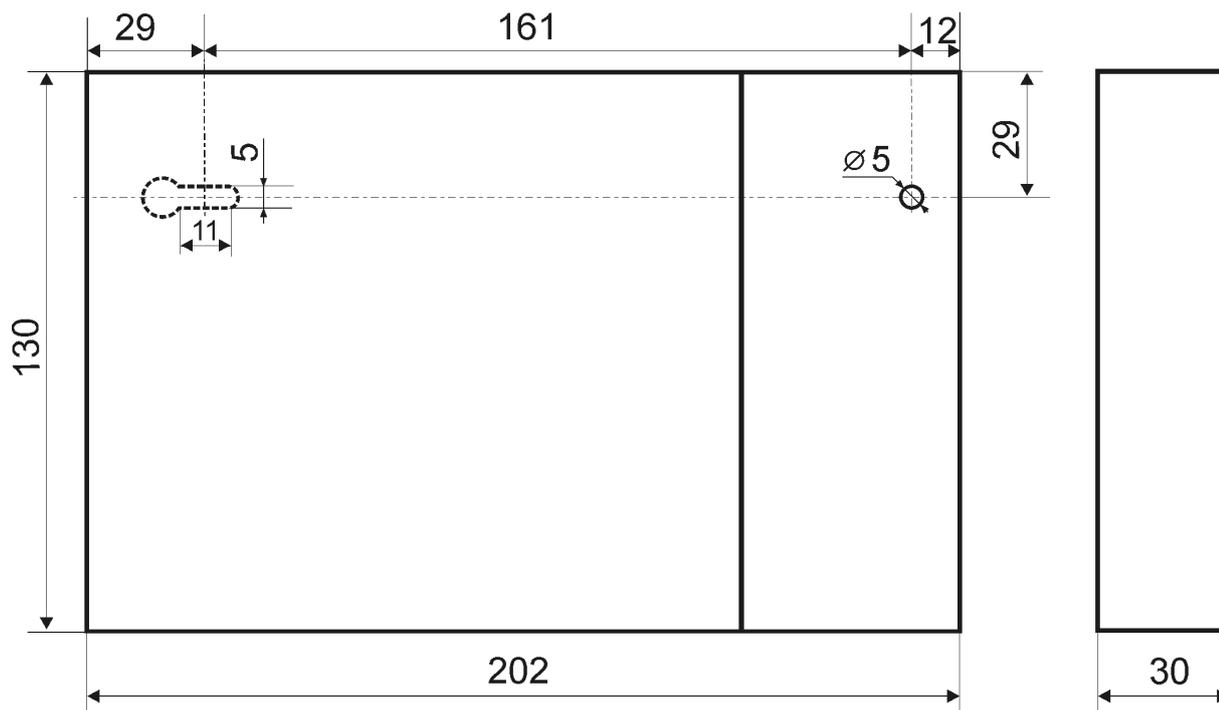
Рис.1 Габаритные и установочные размеры ПКП-1А-1 (исп.1), ПКП-1А-2
