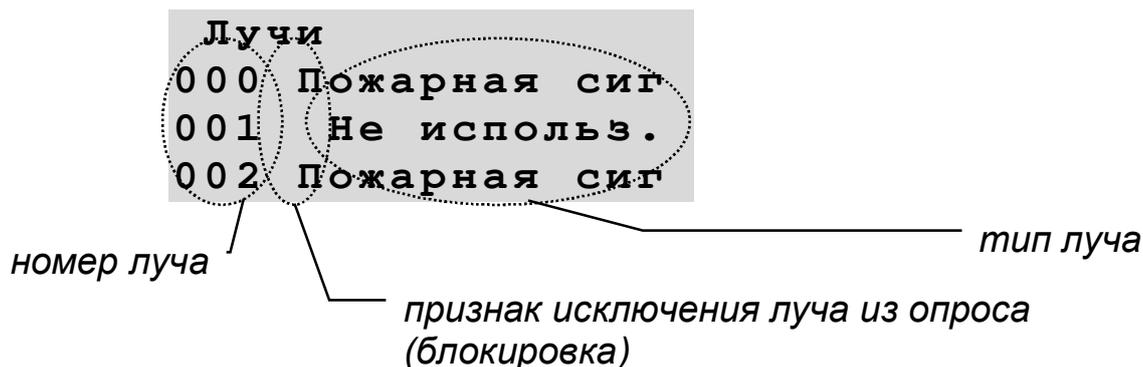
Затем надо подвести указатель к номеру интересующего луча и нажать кнопку ВВОД. При этом на индикаторе появится информация об устройствах, задействованных в луче
