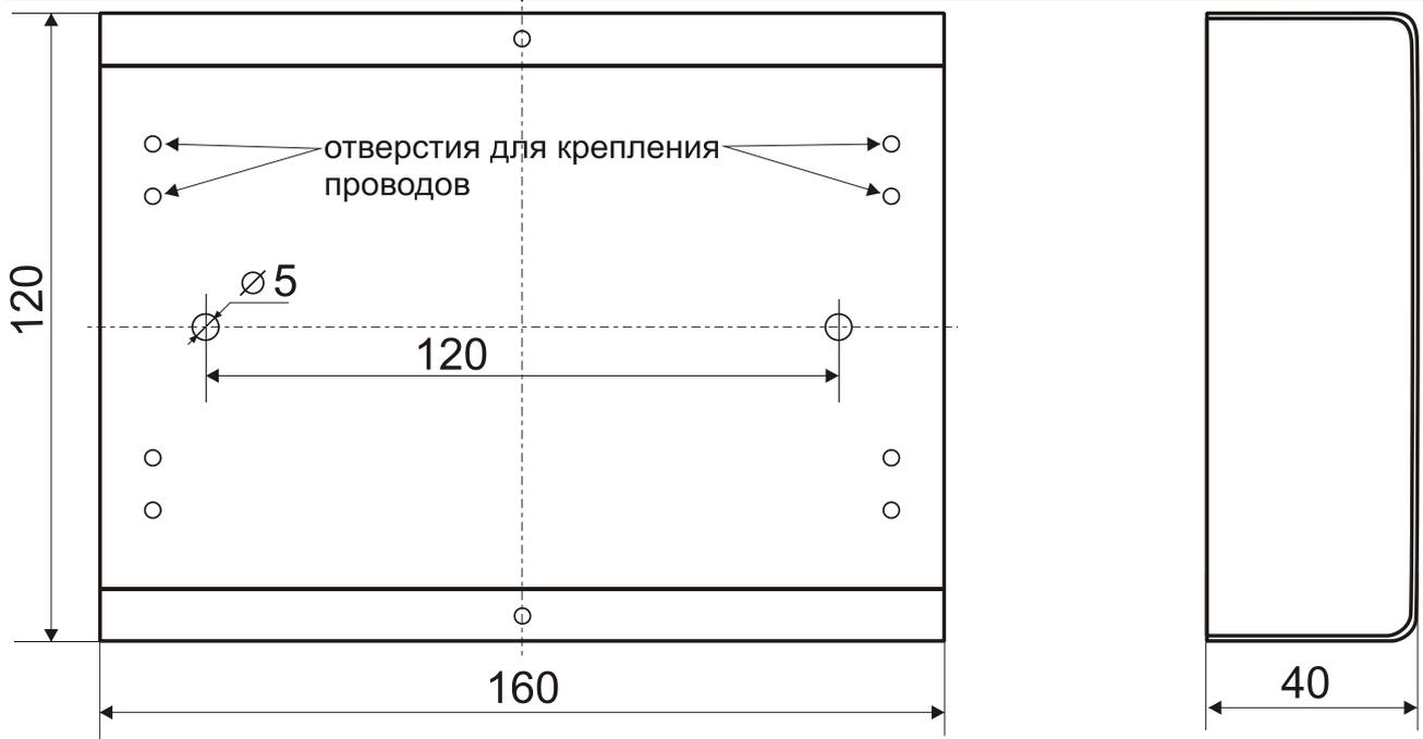
Рис.11 Габаритные и установочные размеры АМК-1 (исп.1)
