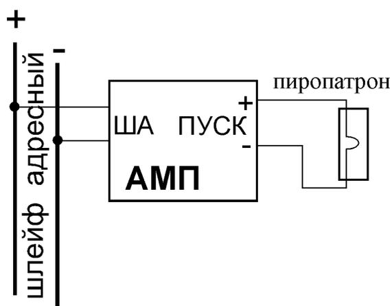
Схема подключения АМП
