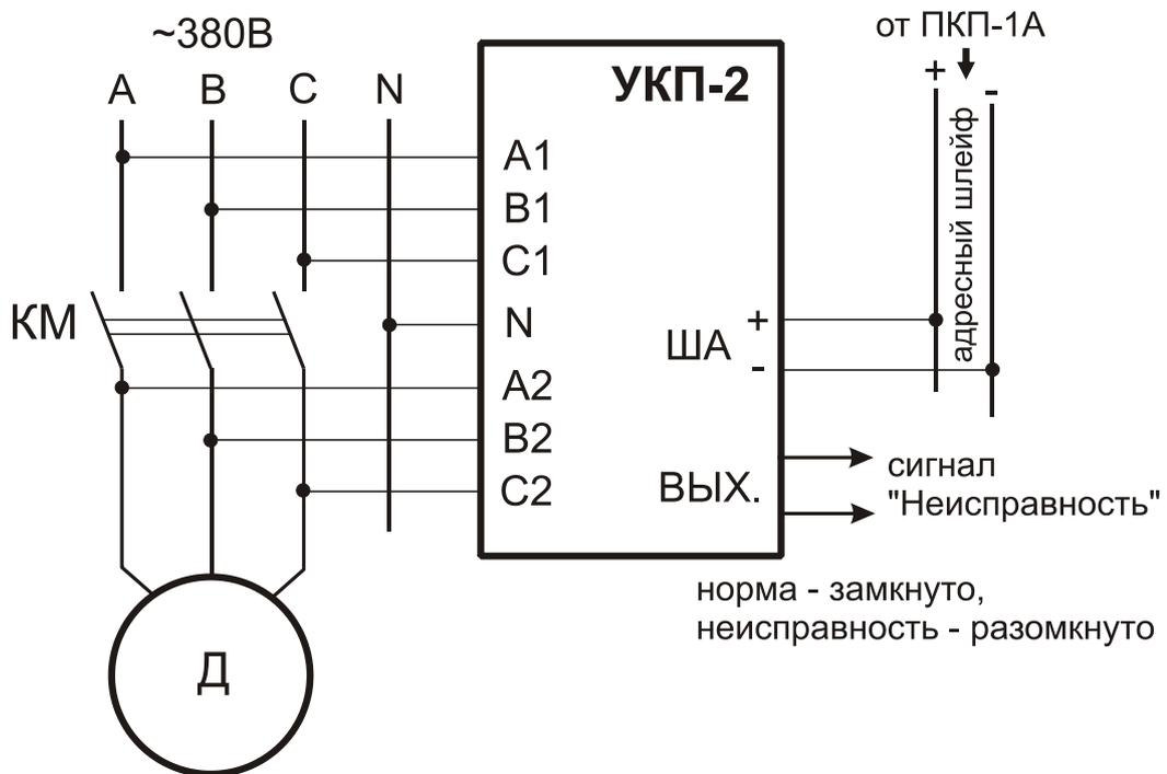
Схема подключения трехфазная
