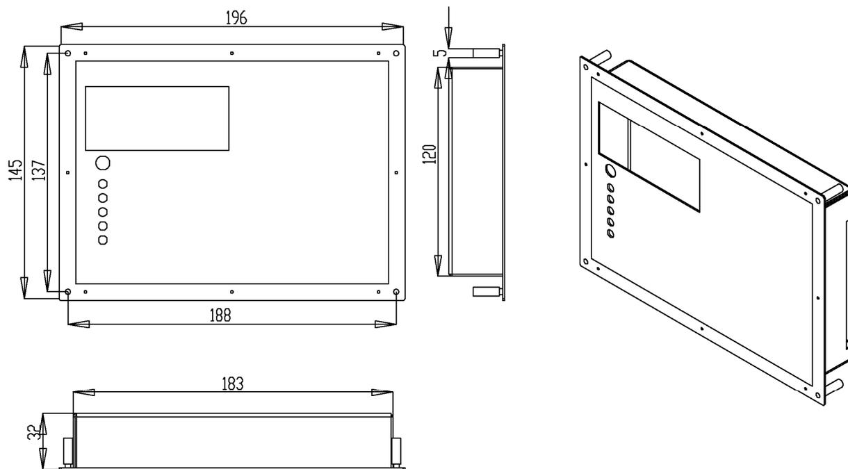
Рис.5 Габаритные и установочные размеры ПКП-1А-1 (исп.2)
