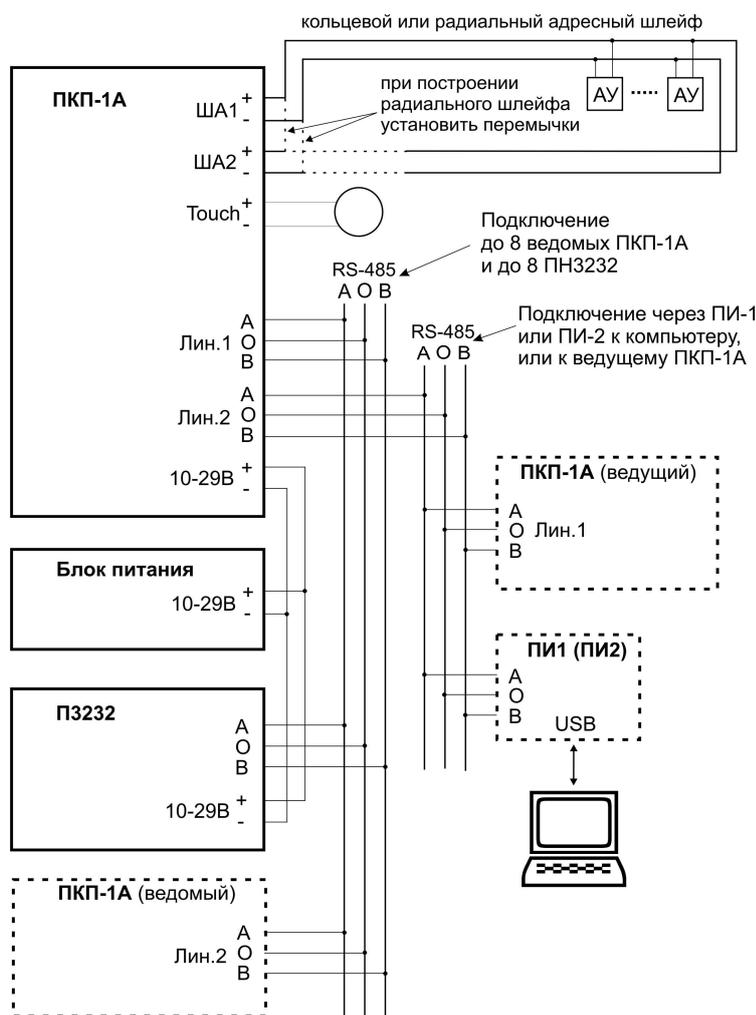
Схема подключения ПКП-1А
