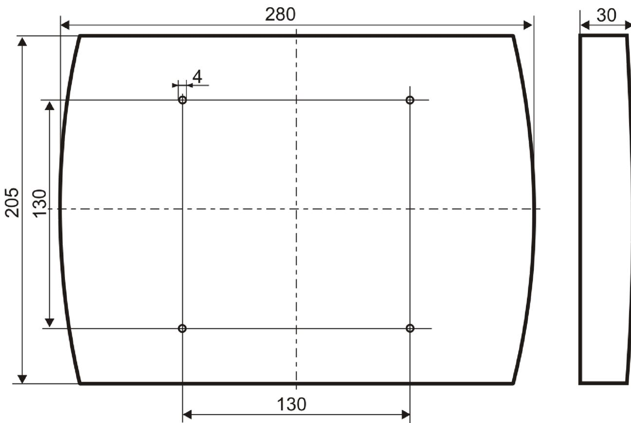
Рис.8 Габаритные и установочные размеры ПН3232 (исп.1)
