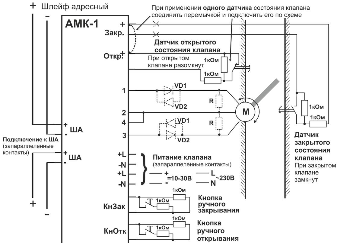
Схема подключения привода с двумя вводами
