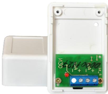
Изолятор адресного шлейфа ИЗО-1 является микропроцессорным устройством и предназначен для изоляции участка адресного шлейфа, формируемого ПКП-1А, при его коротком замыкании. ИЗО-1 является самостоятельным устройством, которое от шлейфа получает только питание. При подключении ИЗО-1 необходимо строго соблюдать полярность.
