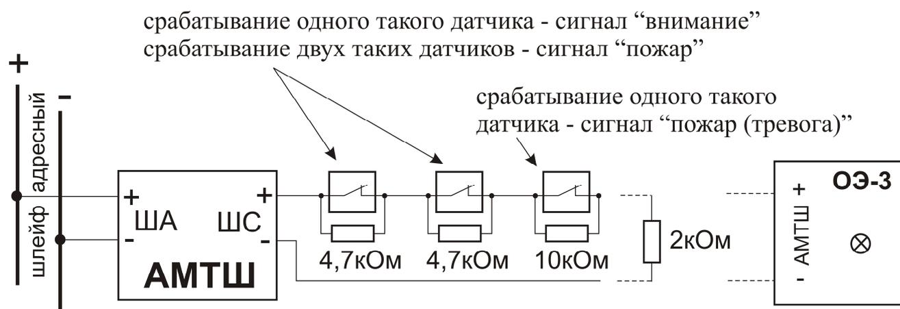
Схема подключения АМТШ
