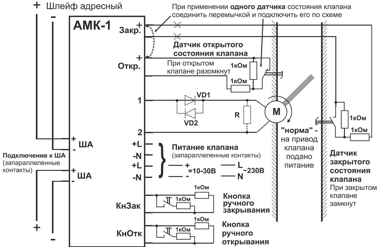
Схема подключения нормально-включенного привода с одним вводом
