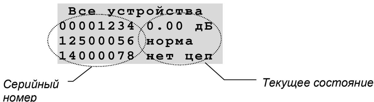
Также возможен и другой вид отображения, где вместо поля «серийный номер», показываются порядковый номер и тип устройства (например, вместо строки «12500056 норма», будет отображаться строка «002 АМДШ норма»). Переключение между этими видами осуществляется нажатием на кнопки  $\leftarrow$  и  $\rightarrow$ .
